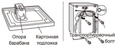
Снимите транспортировочные болты и опоры.
