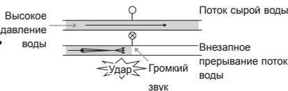
Отрегулируйте давление воды, прикрыв водяной кран.
